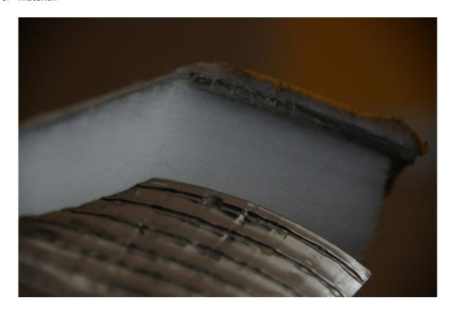
Dämpfungsmaterial: RECYguard W 600 A CS, benötigt werden 2 Platten a 800x1200 mm
